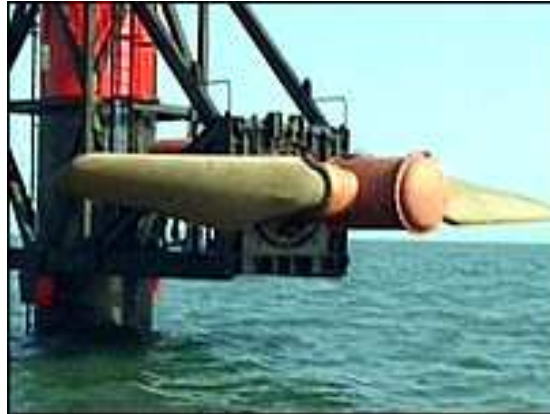
Figura 7. Turbina de 300 kW levantada (posición de mantenimiento)
